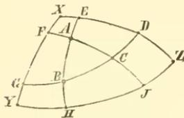
Sind  $A, B, C$  die Pole dreier Flächen, so stellen die Pole  $X, Y, Z$  der Zonenkreise  $BC, CA, AB$  die Punkte dar, in denen die Durchschnittslinien der drei Flächen die Sphäre der Projection treffen. Man findet
